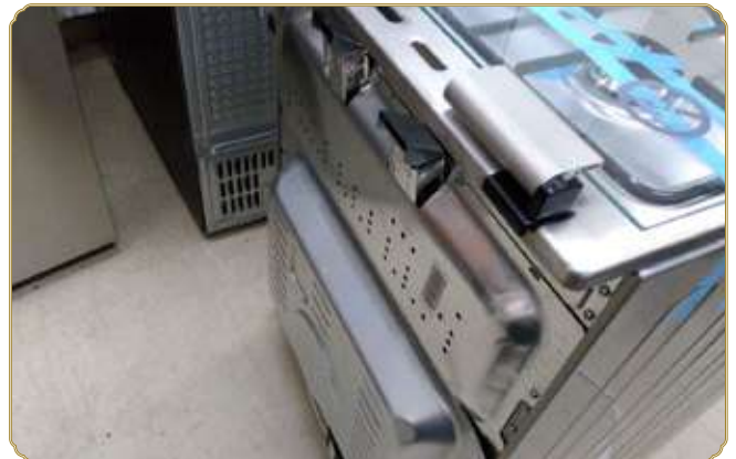
בתמונה ניתן להבחין בפתחי הארובות המסתיימות באלכסון בכדי למנוע הגעת אדי האפיה לסירים המתבשלים על הכיריים
